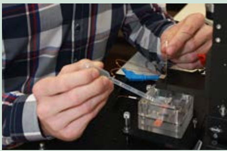
Vorbereitung einer beschichteten Metallprobe für die elektrochemische Analytik
