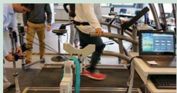
Der RoboWalker als Trainingsgerät nach Gelenkersatz: Abstimmung und Optimierung der Einstellungen vor Einsatz am Patienten
