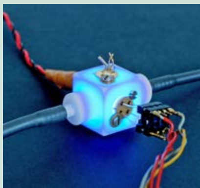
Beleuchtete Messzelle für die photo-aktivierte Gas-Sensorik mit Nanomaterialien
