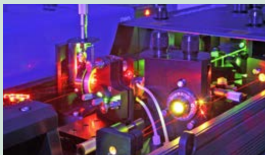
Durchstimmbarer ps-Laser für die kohärente Spektroskopie
