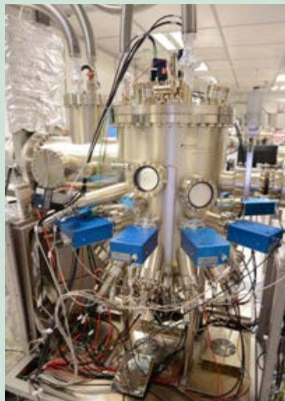
Anlage zur Molekularstrahlepitaxie von Gruppe-III-Halbleitern (Arseniden und Antimoniden)
