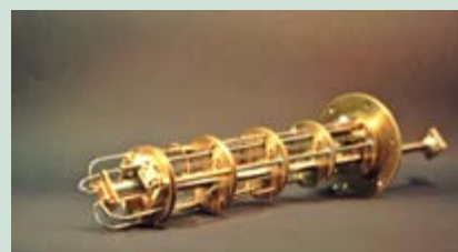
Abb.: rechts: Eigenentwicklung eines Höchstfrequenzkryosystems für elektrisch detektierte magnetische Resonanz
