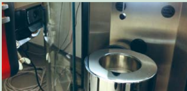
Faser-Tensiometer zur Bestimmung der Benetzbarkeit von Einzelfasern und Faserbündeln
