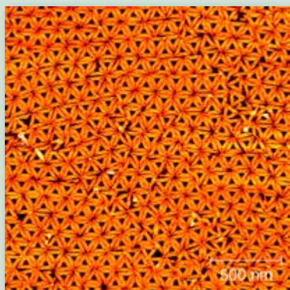
Rasterkraftmikroskopische Aufnahme einer selbstassemblierten Monolage von dreieckigen DNA-Origami-Nanostrukturen
